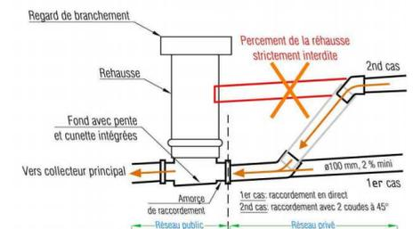
Les couvercles PVC des ouvrages de raccordement seront supprimés chaque fois qu'un tampon fonte est posé. Les canalisations de raccordement seront en PVC ou en polypropylène et auront les diamètres minimums suivants :
