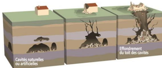
Figure 17 : Le risque d'effondrement des cavités
