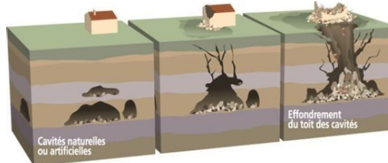
Figure 25 : Le risque d'effondrement des cavités
