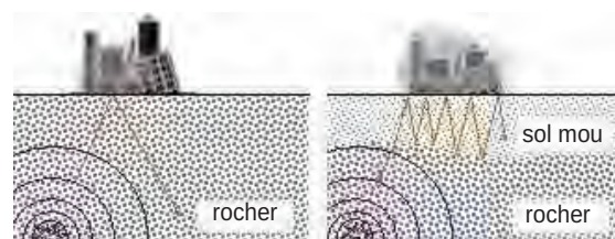
Amplification du signal sismique suivant la nature du sol
