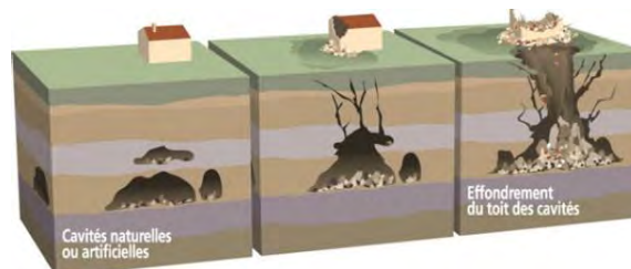
Figure 26 : Le risque d'effondrement des cavités
