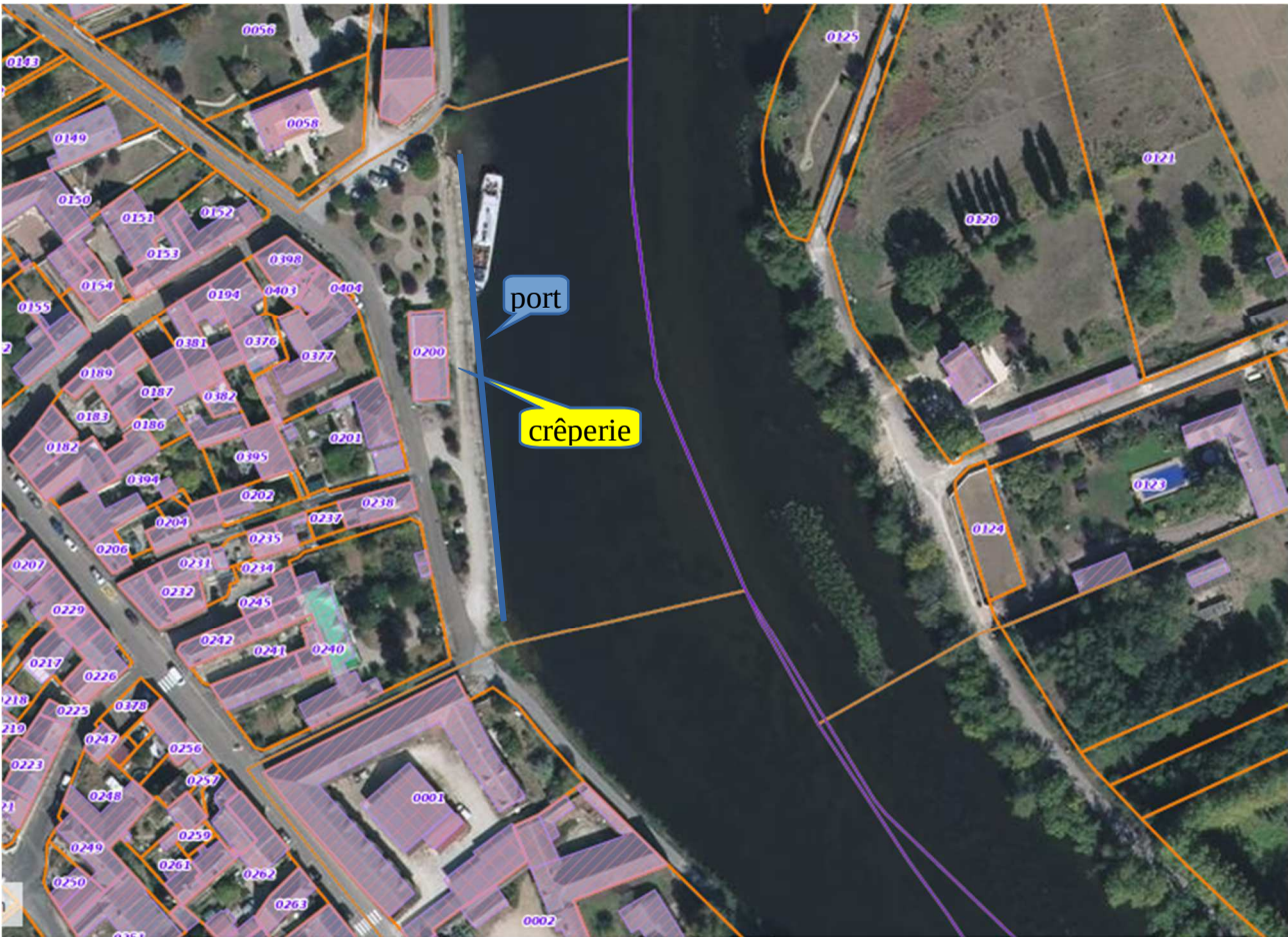
Distribution d'eau et électricité par la crêperie ( batiment 0200, ancienne capitainerie) installée à proximité pendant la haute saison.
