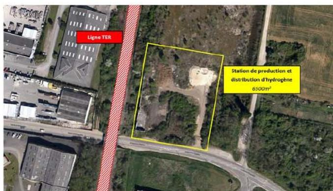
Le schéma d'implantation de la station permet de bénéficier, autant que possible, des anciennes installations industrielles du dépôt pétrolier de Shell, présentes sur ce site jusqu'en 1995, et reprend notamment le tracé des voiries de ce dépôt. Les recherches effectuées au niveau de la DREAL ont permis de confirmer que le site ne souffre pas de pollution particulière et n'est plus soumis à obligation de surveillance.
