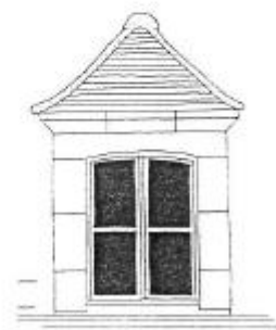
Lucarne engagée maçonnée avec toiture 3 pans en pierre de taille
