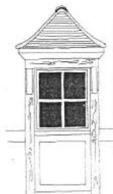
Lucarne engagée dans le mur
